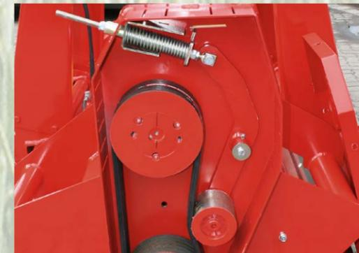
Verstärkter Riemenantrieb mit automatischer Keilriemenspannvorrichtung
