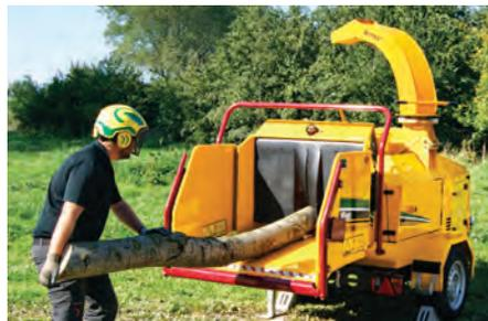
**SICHER IM BETRIEB.** Der Bediener ist rundum geschützt ohne Einbußen beim Zugang zu Motor- und Servicekomponenten hinnehmen zu müssen. Der Einzugsstisch ist mit schwer ausgeführten oberen, seitlichen und unteren Einzugsstoppbügeln versehen und sorgt somit für mehr Sicherheit und weniger ungewollten Unterbrechungen beim Betrieb.
