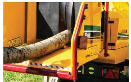
**MARKTFÜHRENDER EINZUG.** Eine 20,3 x 30,5 cm große Einzugsöffnung mit versetzten horizontal gelagerten Einzugsrollen und ein SmartFeed System, das den Einzugs und die Motordrehzahl überwacht, sichern Ihnen eine produktive Häckselleistung ohne große Anstrengung Ihrerseits!
