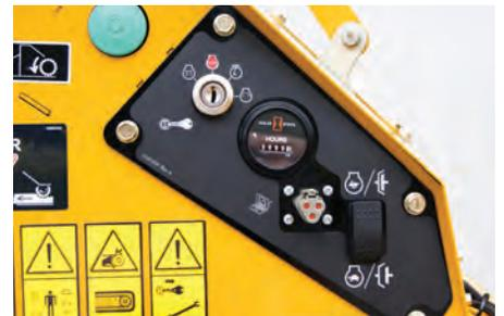
**HÄCKSELN AUF KNOPFDRUCK.** Durch die integrierte Fliehkraftkupplung lässt sich das Schneidwerk auf Knopfdruck starten, dies vereinfacht nicht nur den Betrieb der Maschine sondern schließt Fehlbedienungen vollständig aus.
