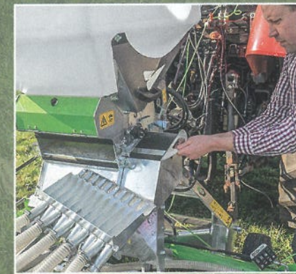
Die Abdrehrprobe mit integrierter Wanne und Fernbedienung für den Abdrehstart sind vorbildlich.
