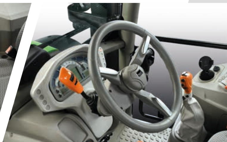
> Inverseur électrohydraulique PowerShuttle avec SenseClutch à 5 niveaux de réglage et fonction Stop&Go.
