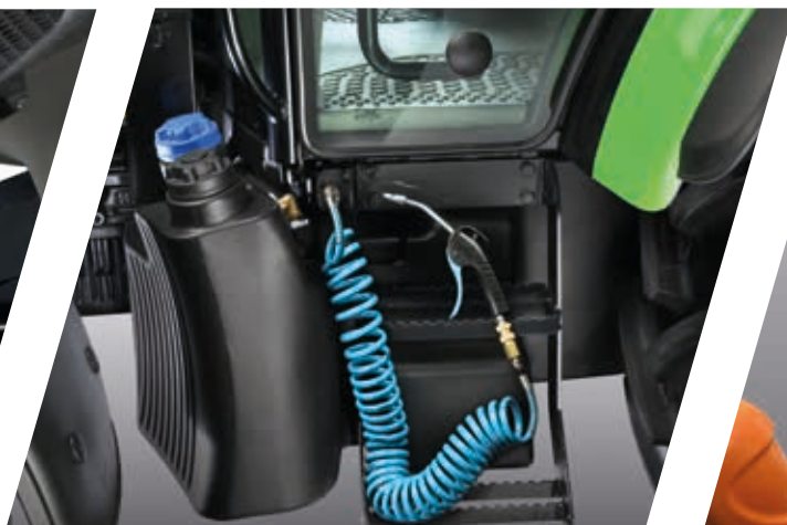
> Raccords d'air externes et en cabine pour les accessoires du compresseur d'air.
