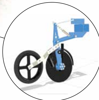
Doppelscheibenschar für gleichmäßigen Feld- aufgang
