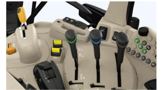
AutoPowr™ an der rechten Bedienkonsole mit mechanischen ZSGs
