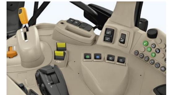
AutoPowr™ an der rechten Bedienkonsole mit elektrischen ZSGs
