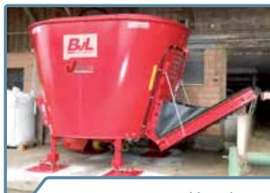
EDS Austrag mit klappbarem Fördererlevator
