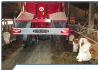
EDS Austrag hinten links und rechts in der Rundung
