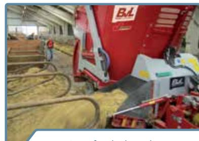
Querrörderband vorne mit klappbarem Förderelevator
