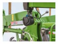
Mit Fendt Cargo-Lock klappt der An- oder Abbau in Minutenschnelle. Die Stützen lassen sich werkzeuglos entriegeln. Der Cargo steht immer fest und sicher.
