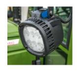
Für rundum optimale Ausleuchtung bei nächtlichen Arbeiten mit dem Fendt 200 Vario sorgen auf Wunsch die LED-Arbeitsscheinwerfer vorne und hinten.
