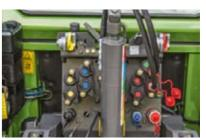
Im Heckanbauraum sind alle Anschlüße dauerhaft gekennzeichnet und aufgeräumt angeordnet. Die selbstschließenden Ventilkappen verhindern Schmutzeintrag.
