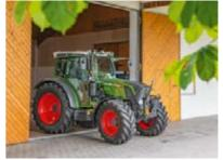
Der kompakte Fendt 200 Vario eignet sich mit seiner minimalen Bauhöhe von 2.480 mm bei einer Bereifung von 480/70R30 auch zum Einfahren in niedrige Gebäude.
