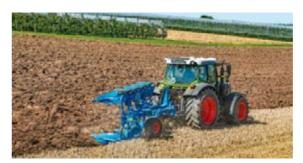
Die Allrad- und Differentialsperrenautomatik schaltet in Abhängigkeit vom Lenkwinkel und der Geschwindigkeit. Per Tastendruck können Sie in jeder Situation Allrad und Differentialsperre manuell zuschalten.
