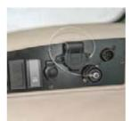
Im Fendt 200 Vario ist alles zentral zusammen gefasst wie z. B. die Stromversorgung und Signalsteckdose für externe Geräte.
