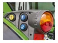
Die Externbedienung für das Hubwerk und die Heckzapfwellenschaltung. Damit bauen Sie Heckgeräte sicher an und sparen sich unnötige Wege, beispielsweise beim Befüllen des Güllefasses.
