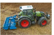
Mit der VarioActive Überlagerungslenkung erreichen Sie den vollen Lenkeinschlag mit nur einer Lenkradumdrehung, was sich bei Frontladerund Hofarbeiten und am Vorgewende auszahlt.
