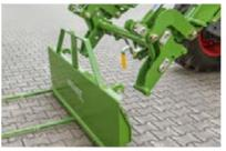
Ein Hebel am Schnellwechselrahmen entriegelt das Werkzeug bequem mit einem Handgriff. Beim Anbau verriegelt das Werkzeug beim vollständigen Einkippen automatisch.
