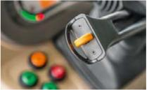
Mit dem links unter dem Lenkrad angeordneten Taster bedienen Sie einfach und komfortabel die Wendeschaltung und die Stop&Go Funktion.
