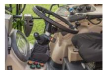
Der Fahrmodus ist individuell wählbar: Die Geschwindigkeit regelt entweder das Fahrpedal oder der Variostick.
