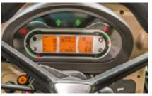
Einfach umstellbare Multifunktionsanzeige: Lassen Sie sich das Anzeigen, was Sie für Ihre Arbeit benötigen, z. B. den aktuellen und den durchschnittlichen Kraftstoffverbrauch oder die bearbeitete Fläche.
