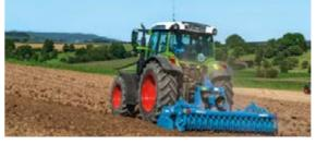
Bei jeder Geschwindigkeit arbeiten Sie mit der passenden Zapfwellendrehzahl dank unabhängiger Regelung von Fahrgeschwindigkeit und Motordrehzahl.
