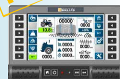
Boitier Rollcontrol G2 Maintenance de la dose cible grâce à la pesée dynamique couplée au DPAE.
