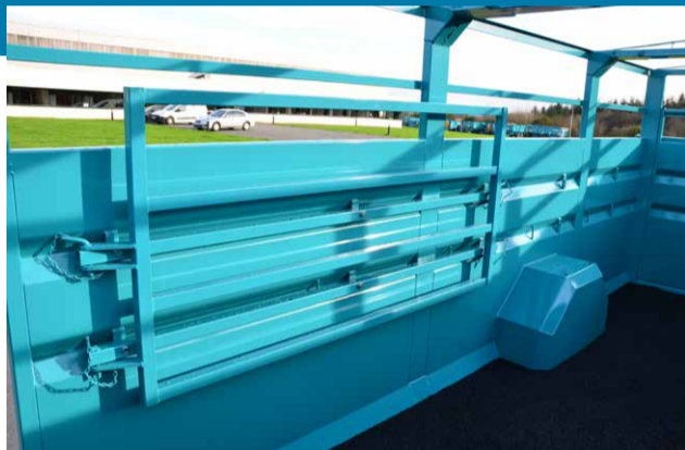
Barrière de séparation intérieure, 1 partie, 2 positions
