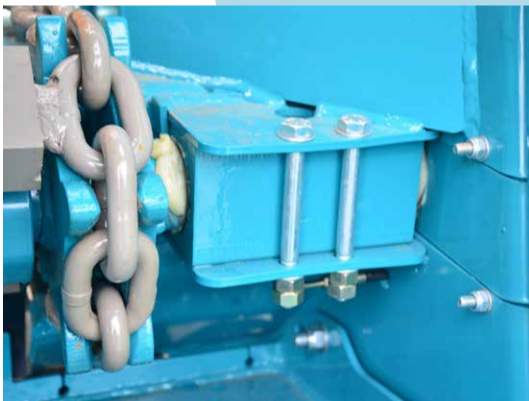
Tapis à double chaînes marine Twin chain with marine chains Automatische Kettenspannung Bodemketting met gecalibreerde ketting Tapiz de fondo con cadenas tipo «marina»
