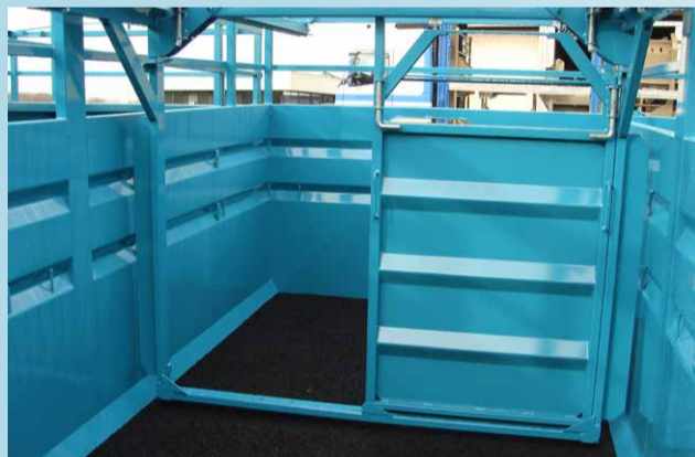
Barrière suspendue 1 porte coulissante avec sécurités anti-retour
