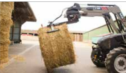
Wenn man auskippt, gleitet der Greifer mit dem Ballen durch die Schwerkraft am vertikalem Mast entlang.
