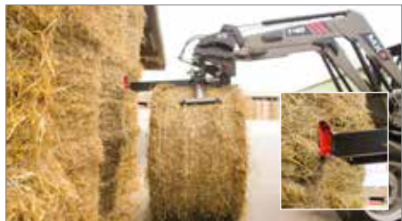
Greifer in niedriger Position, man drückt mit dem Schieber, um den Greifer herauszuziehen.
