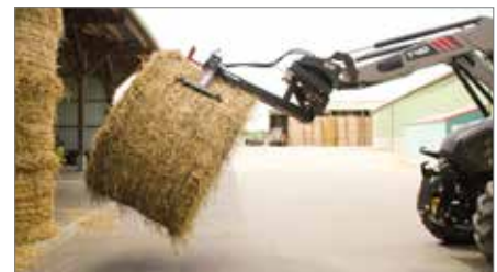
Der Greifer verriegelt automatisch in der oberen Position.
