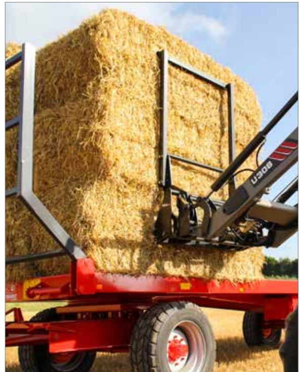
Stapelkapazität: 2 Rundballen oder 3 Quaderballen
