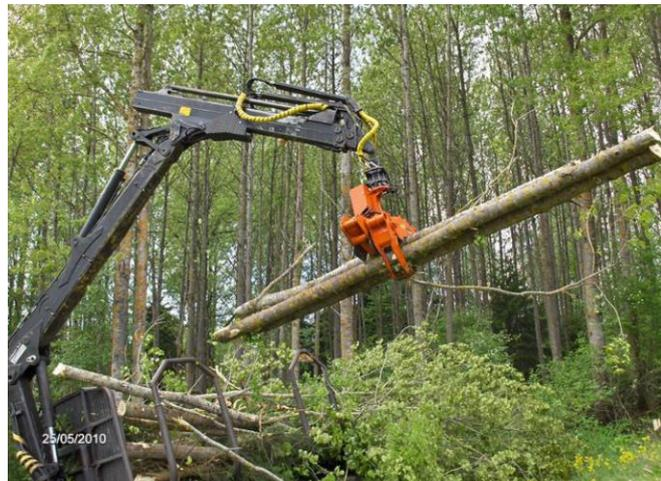
Biojack Energieholzgreifer sind in verschiedenen Grössen mit und ohne Sammelaggregat erhältlich. Für grosse Durchmesser kommt der Biojack 400 mit Kettensäge oder als Kombigerät mit Säge und Messer zum Einsatz. Anbau an Kran oder Bagger.
