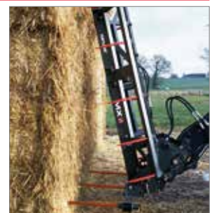
Feste oder variable Tragezinken für leichtes und sicheres Einziehen.
