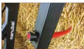
Eigene Befestigung der Greiferzinken (ohne Spiel).
