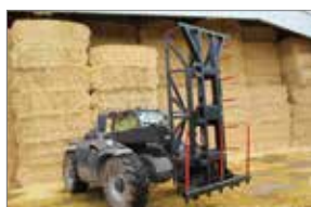
Einklappbare Tragezinken für eine sichere Fahrt.
