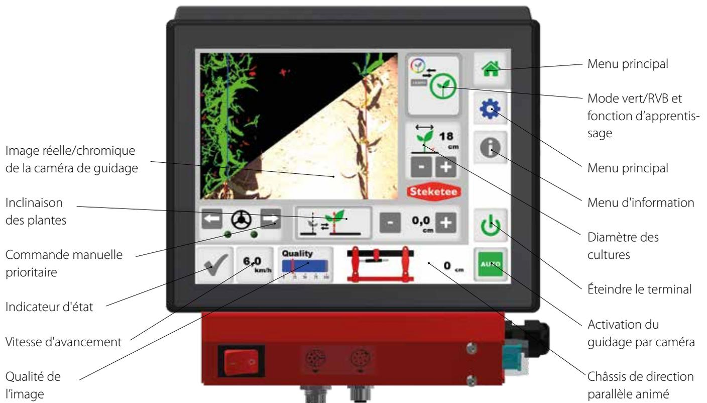
La fonctionnalité et les options de réglage du guidage par caméra **IC-Light** sont expliqués ici:
