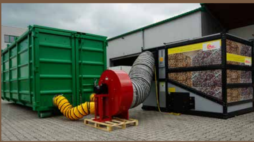
Die Containertrocknung ist ebenfalls mit Kiemensblechen ausgestattet und wird von einem LandriTherm Hackgutofen LA 250 beheizt.
