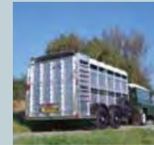
Die Anhänger sind in den Längen von 3,00 m, 3,66 m und 4,27 m und mit einer Höhe von 1,83 m bzw. 2,13 m erhältlich. Mit einer optionalen Mitteltrennwand ausgestattet, die 2,13
