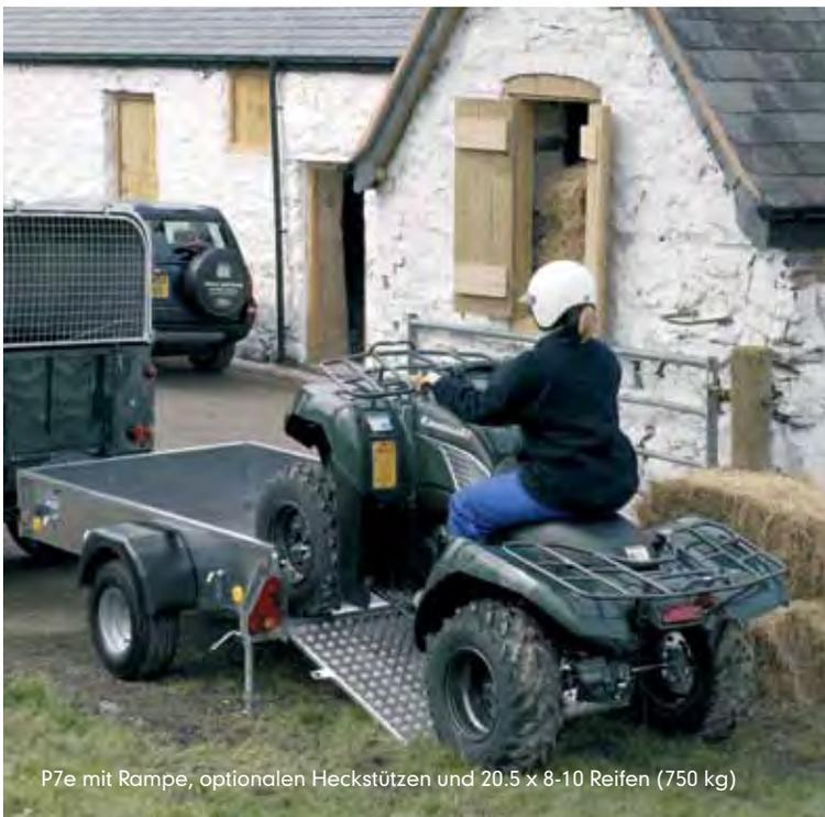
P7e mit Rampe, optionalen Heckstützen und 20.5 x 8-10 Reifen (750 kg)
