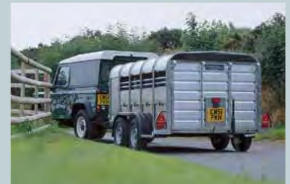
Die TA5 Modelle mit 1,20 m Kopfhöhe sind in Längen von 2,44 m, 3,00 m und 3,66 m erhältlich.
