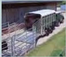
Die Modelle TA5 1,83 m und 2,13 m sind in den Längen von 2,44 m, 3,00 m und 3,66 m erhältlich. Die 2,44 m und 3,00 m Ausführungen haben ein maximal zulässiges Gesamtgewicht von 2.700 kg, wohingegen die schwere 3,66 m Version ein maximal zulässiges Gesamtgewicht von 3.500 kg bietet.
