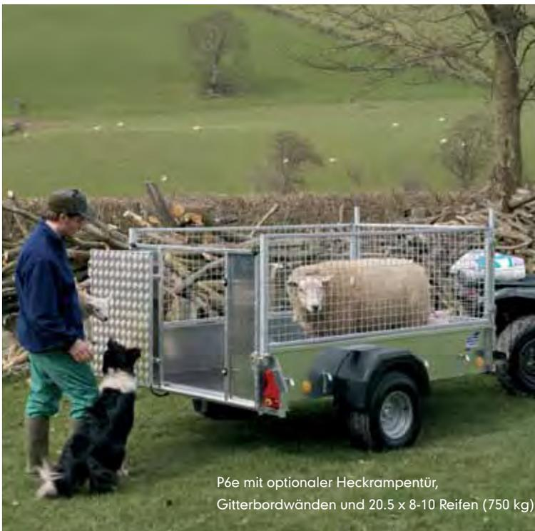
P6e mit optionaler Heckrampentür, Gitterbordwänden und 20.5 x 8-10 Reifen (750 kg)
