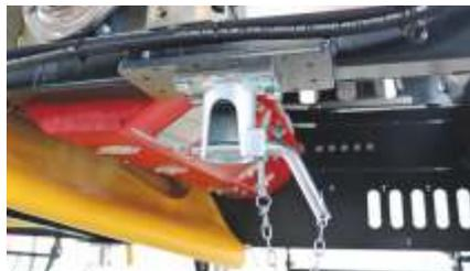
Pour une utilisation à court terme sur le terrain, le tapis d'alimentation peut être démonté en 5 minutes et il est possible de travailler sans aucune restriction visuelle sur les éléments d'alimentation.
