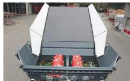
La glissière est composée de parois pliables en aluminium en plusieurs parties et peut être rabattue de 180° sur le doseur par le truchement du système hydraulique.
