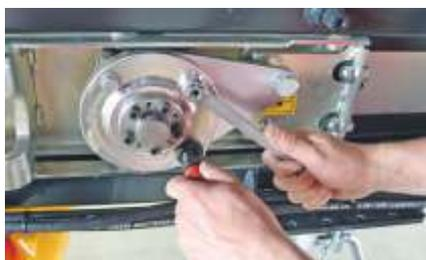
Le débit est adapté aux différentes conditions au moyen du déplacement hydraulique du rotor et de la vitesse du rotor.
