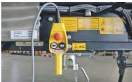
La boîte à boutons sert exclusivement à contrôler les rotors et contient les fonctions «Rotor gauche stop/marche arrière» et «Rotor droit stop/marche arrière». Les autres fonctions («Rotors ouvrir/fermer», «Tapis d'alimentation avant/arrière» et «Goulotte monter/descendre») sont commandées par l'intermédiaire des contrôleurs du tracteur. Par conséquent, 4 contrôleurs à double effet sont nécessaires dans la version de base!
