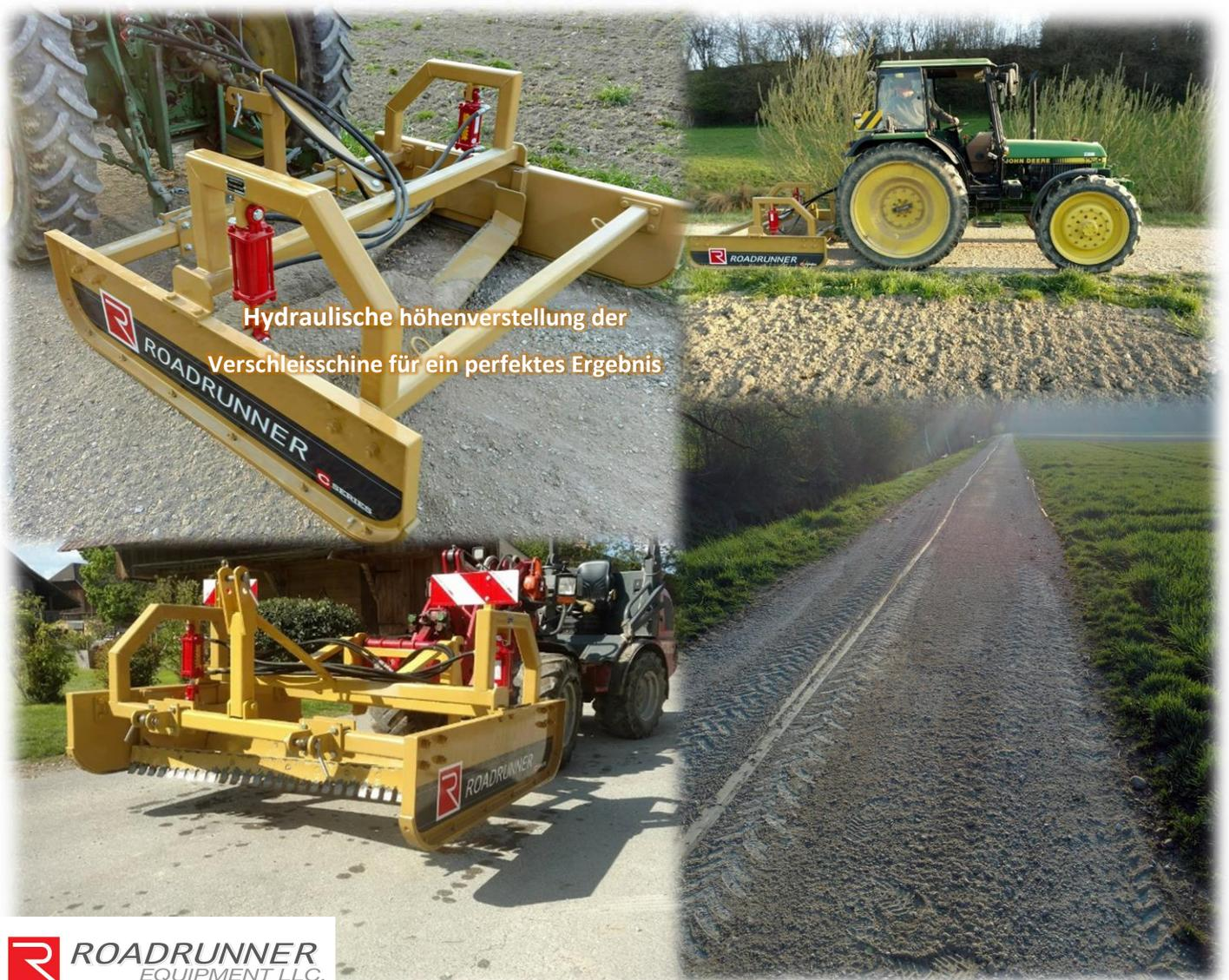
Hydraulische höhenverstellung der Verschleisschne für ein perfektes Ergebnis
