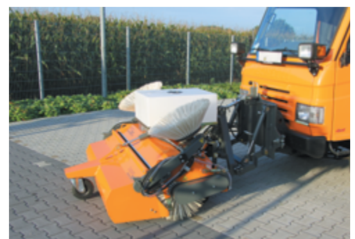
Anbau am Kommunalfahrzeug, hydraulischer Aushub
