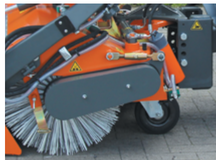
Stufenlose Kehrwalzenverstellung (Spannschloss)
