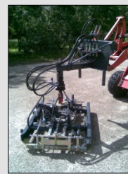
Pflaster Verlege Maschine
