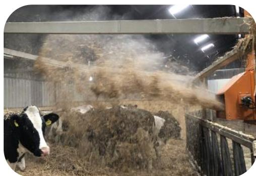
En option, il est possible de monter une unité pour épandre jusqu'à 6 mètres de distance. En combinaison avec une bande de transport, l'épandage est possible à gauche ou à droite.
