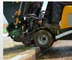
System mit 2 Rädern um 20mm Stufe zu steigen
