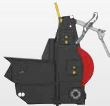
Automatisches Lenkblech - Position von Ladung des Ballens
