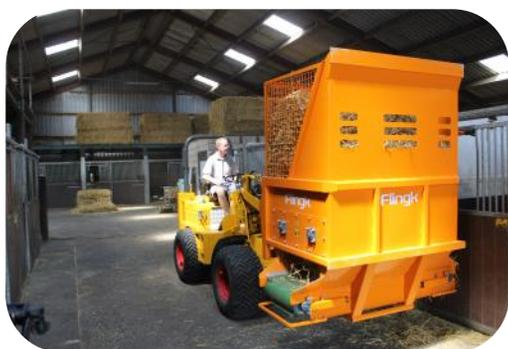
Mit dem für die kleine Lader gebauten SVV 1000 kann ein dritte bis halber Ballen von 2500x1200x900 mm verteilt werden. Hier ein Bild mit 1800x700 Förderband, um links und rechts auf bis zu 2,5 bis 3 Meter ein zu Streuen.
