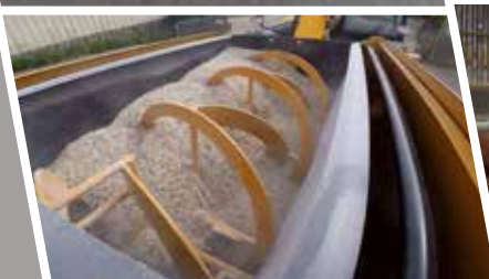
Funktioniert mit 1 DW: eine Richtung für die Mischung /eine Richtung für die Verteilung
