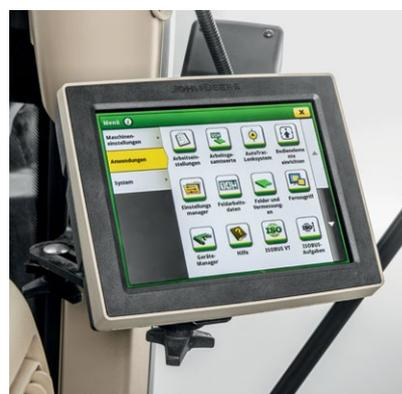
Das 4240 Universal-Display ermöglicht die Nutzung von AutoTrac™ Complete und bietet fortschrittliche Automatisierungsfunktionen wie Teilbreitensteuerung und Dokumentation für Ihren 6M.
