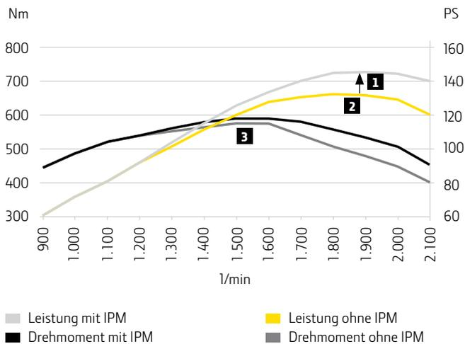
Intelligent Power Management (IPM) (1) stellt für Transport- und Zapfwellenarbeiten eine Zusatzleistung von bis zu 20 PS zur Verfügung. Maximale Motorleistung (2) und maximales Drehmoment (3) werden bei 1.900 bzw. 1.500 1/min erzielt, um ein optimales Ansprechverhalten bei niedrigem Kraftstoffverbrauch zu garantieren.
