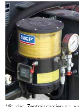
Mit der Zentralschmierung werden alle Schmierstellen automatisch mit Fett versorgt, auch an schwer zugänglichen Stellen.
