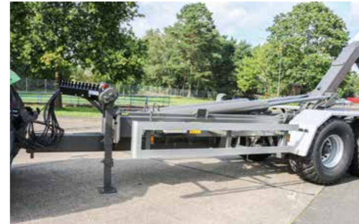
Der seitliche Anfahrtschutz erhöht die Sicherheit im Straßenverkehr.
