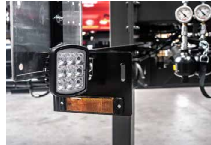
LED-Arbeitscheinwerfer wahlweise vorne, im Fahrzeugheck gehören Seitenmarkierungs- und Positionsleuchten zum Standard.
