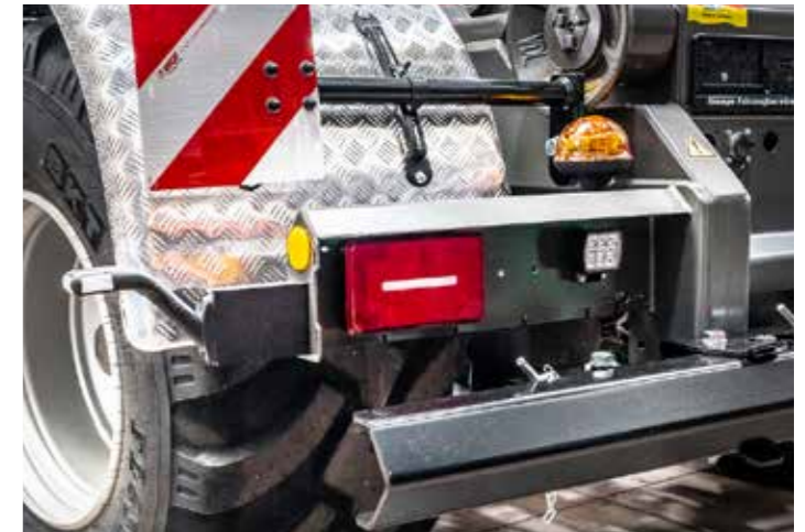
Die großen LED-Rückleuchten sind in einem massiven Schutzgehäuse untergebracht, seitliche Positionsleuchten im Heck dienen dem Fahrer zur besseren Übersicht.
