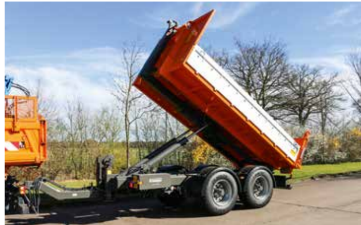
Der steile Kippwinkel von 47–55° (modellabhängig) lässt keine Wünsche offen. Kaum ein Hersteller bietet ein so umfangreiches Programm an Abrollkippern und Sonderzubehör. Nutzen Sie unsere jahrzehntelange Erfahrung!
