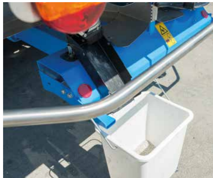
Abdrehprobenset bestehend aus Auffangbehälter und Streutabelle.
