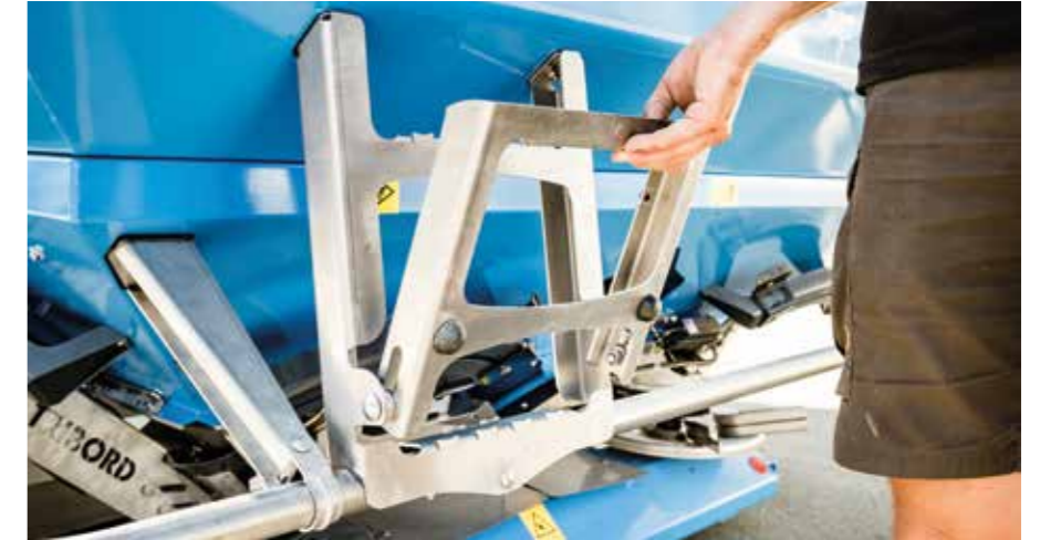
Klappbare Treppe ermöglicht einen komfortablen Einblick in den Behälter.
