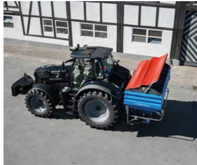
Aufrollplane in manueller oder hydraulischer Ausführung.
