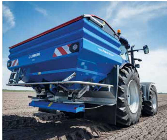
Hydraulischer Antrieb für eine konstante Scheibendrehzahl auch in Hanglagen.
