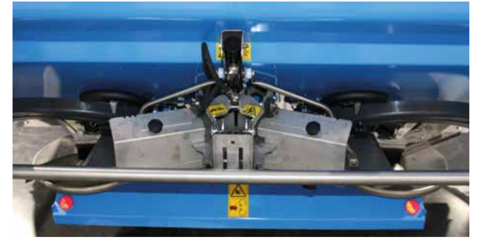
Hydraulisch absenkbarer Grenzstreuschirm für das Streuen auf halber Arbeitsbreite und von der Grenze ins Feld.
