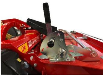
Komfortable Einstellung der Intensität. Verstärkung des Konditionierungsblechs in 5 Stufen und Gegenkamm mit 3 Stufen - beide Hebel haben eine Einstellskala.
