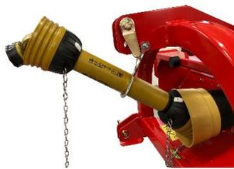
Halterung für Gelenkwelle wenn die Maschine abgekoppelt ist.
