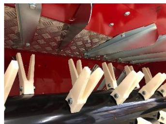
Konditionierungsblech aus geriffeltem Aluminiumblech und verschleißfeste Polyurethan-Aufbereiterzinken für beste Aufbereitungsergebnisse. Mit 14 verstellbaren Leitflügeln kann die Ablagebreite eingestellt werden.
