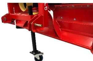
Das optionale Rangierrad unter dem Stützfuß erleichtert das An- und Abkoppeln an den Schlepper. Das Rad ist mit einer Arretierungsbremse ausgerüstet.
