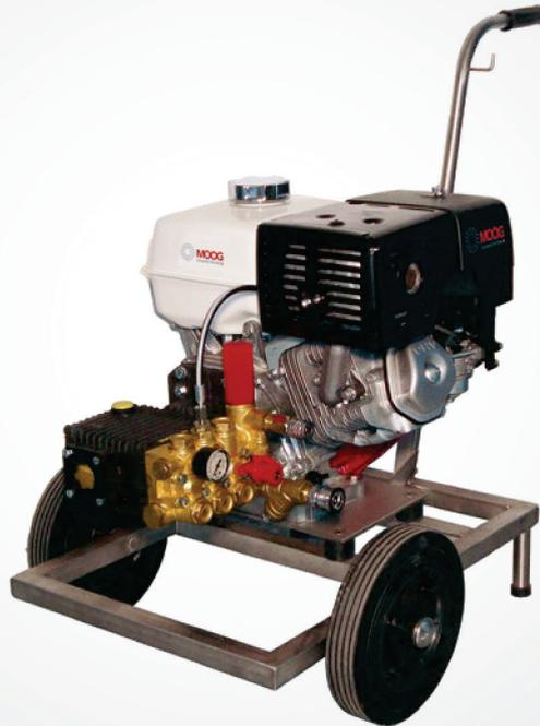
Stromunabhängige Reinigung mit bis zu 170 bar Arbeitsdruck. Der leistungsstarke Hochdruckreiniger mit luftgekühltem Benzinmotor ist optimal einsetzbar, wenn keine Stromversorgung verfügbar ist.
