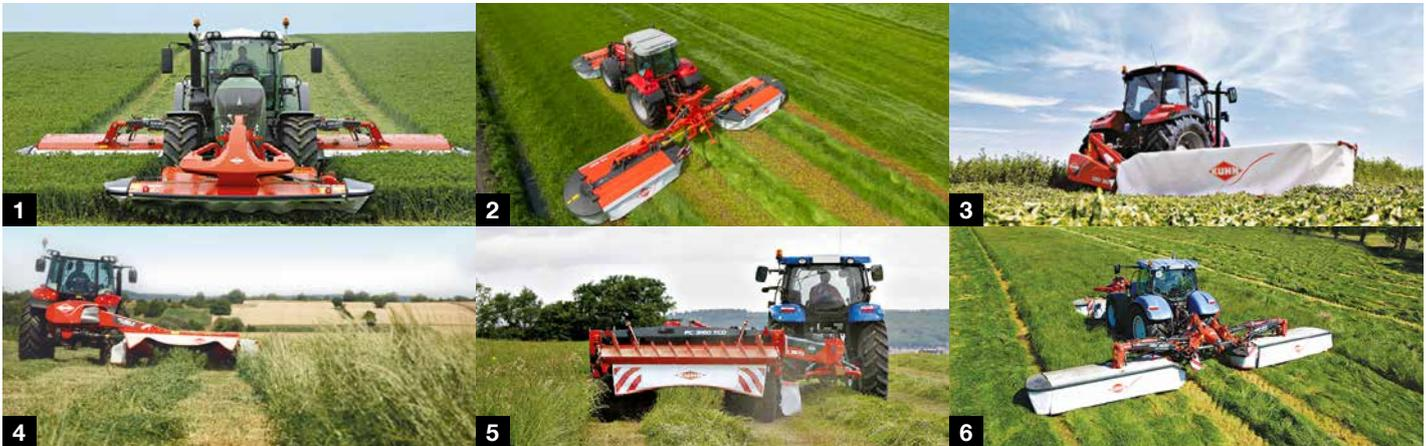
1. Front-Scheiben-Mähknickzetter - 2. Front- und Heck-Trommelmäher - 3. Angebaute Scheibenmäher - 4. Angebaute Scheiben-Mähknickzetter
