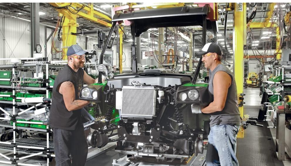
Fertig! Die Monteure Mike Bednar und Craig Miller schrauben das Insassenschutzsystem am Gator Rahmen fest.
