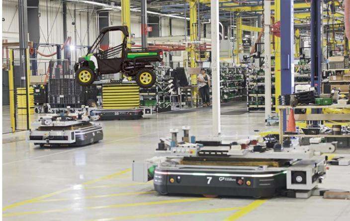
Ein mobiler Roboter namens OTTO lädt an einer Docking-Station auf. OTTOs versorgen die Montagelinie ständig mit Komponenten, um die Produktion reibungslos am Laufen zu halten.
