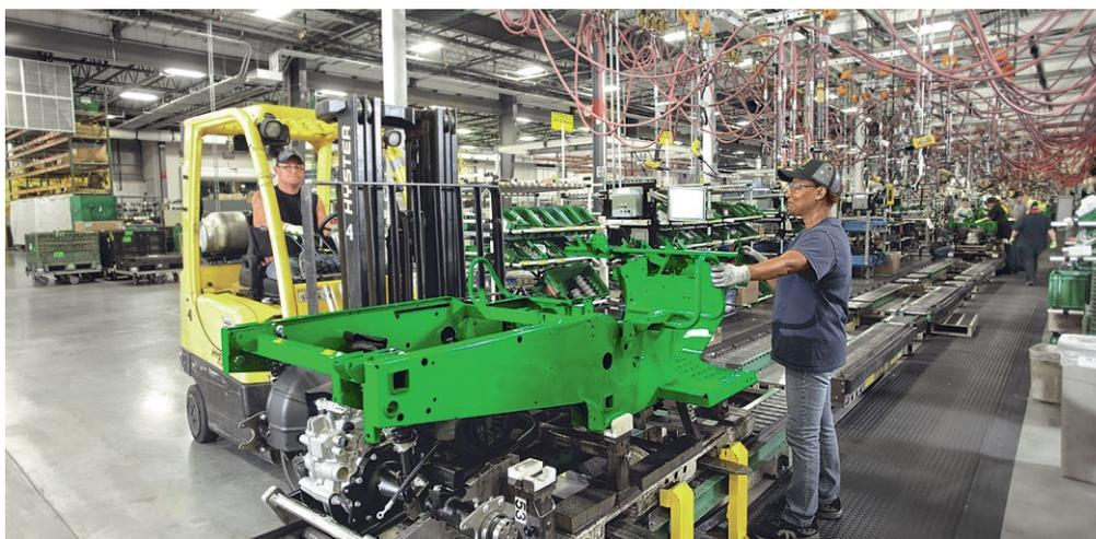
Ein traditioneller T-Serienrahmen wird mit Antriebsstrang auf der Montagelinie platziert. Er verlässt die Montagelinie als komplett montierter Gator der T-Serie.
