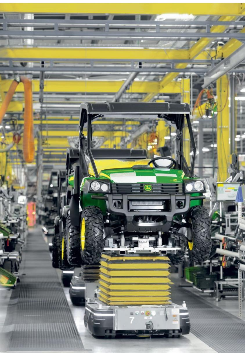
Nach Auftrag gefertigte Gator-Fahrzeuge – versandfertig. Für maximale Flexibilität können nun alle unterschiedlichen Konfigurationen auf den zwei Montagelinien im neuen Werk montiert werden.
