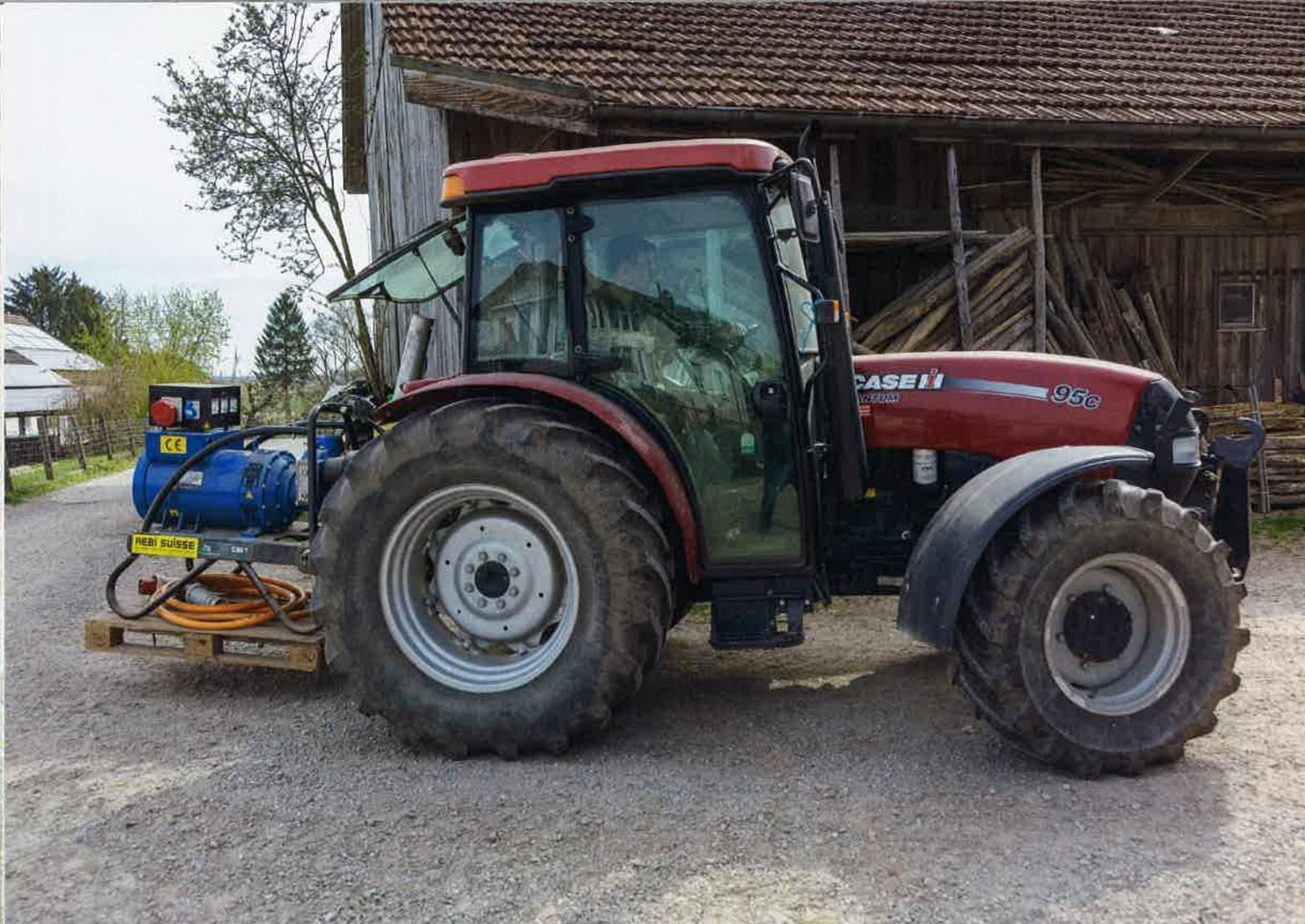
Im Notfall muss es schnell gehen. Adrian Sager fährt den am Dreipunkt angehängten Zapfwellen-Generator auf einer Holzpalette mit dem Traktor an Ort und Stelle, wo er gebraucht wird.
