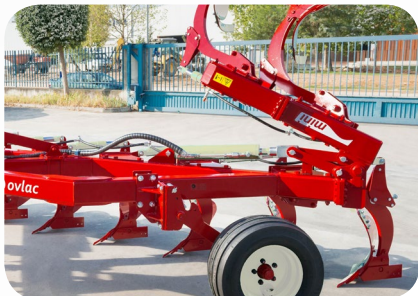
Hydraulisch klappbare Zusatzaufbauten für weniger Gewicht und Länge beim Transport (nur Mini-BF und HF)
