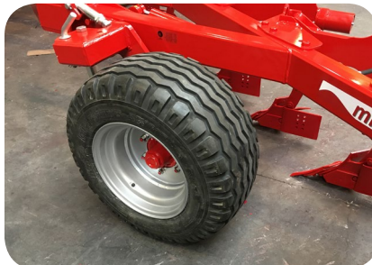
Stütz- und Straßentransportrad hinten. Für Entlastung der Traktorhydraulik beim Straßentransport. Empfehlung für Pflüge > 7 Scharen
