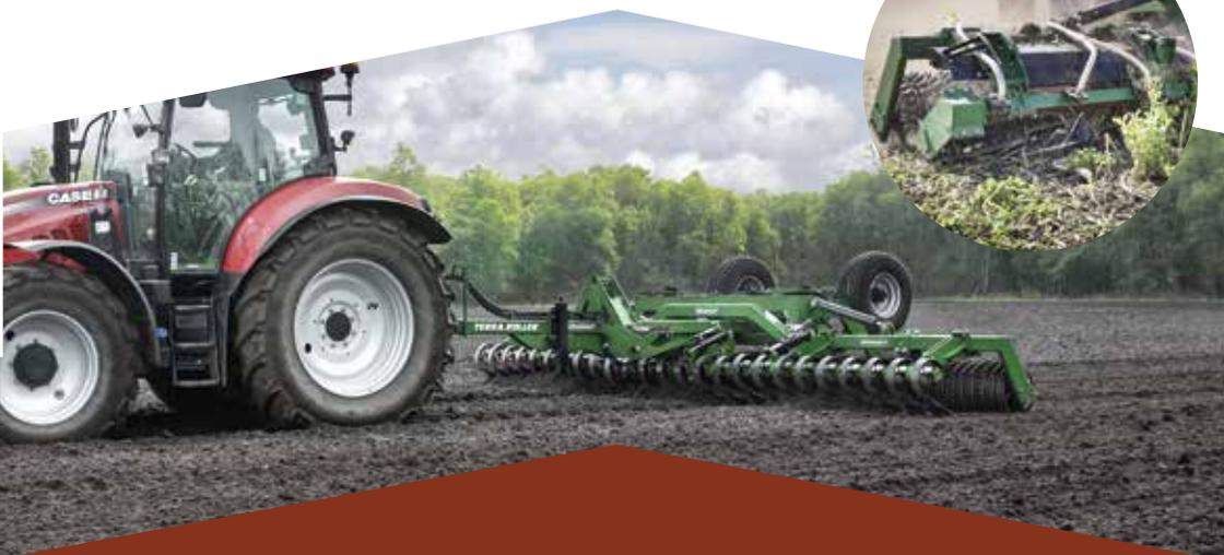
Auf Wunsch kann der **TERRA.ROLLER** expert mit Säeinrichtung geliefert werden. Die ebenfalls optional erhältliche Druckluftbremsanlage sorgt für eine sichere Straßenfahrt.
