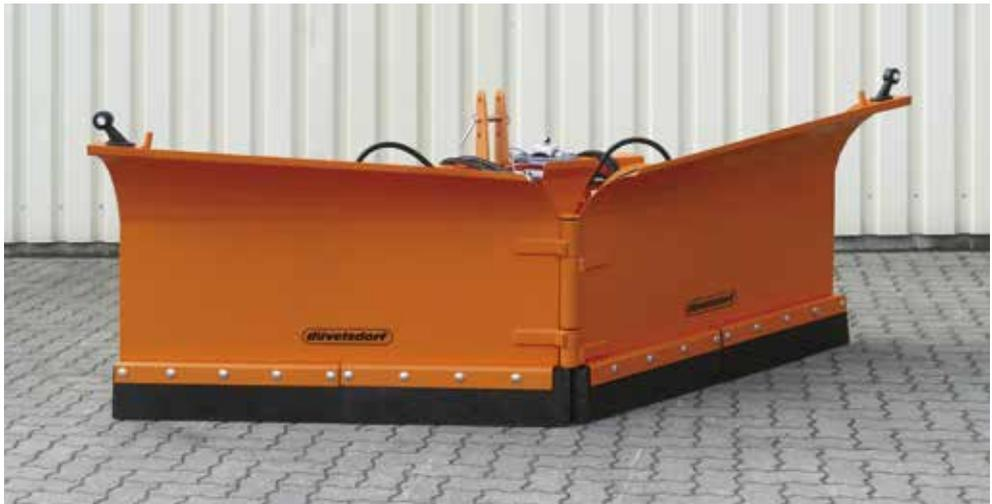
Der düvelsdorf Schneepflug besteht aus zwei mittig gelagerten Scharflügeln, die hydraulisch individuell verstellbar sind. Durch die flexiblen Einstellmöglichkeiten links, rechts, gerade und als Pflug ist das Schneeschild optimal einsetzbar in den verschiedenen Geländen wie Straßen, Plätzen und Höfen.
