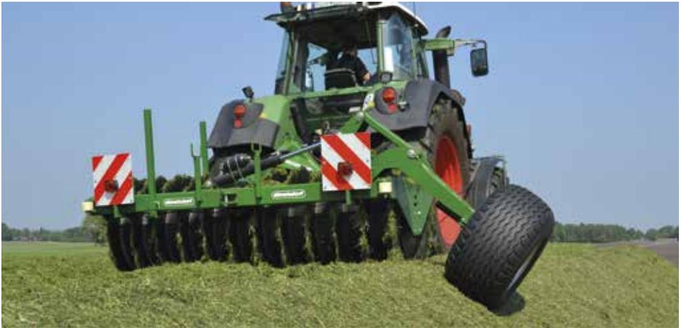
Die Silagewalze bietet mit ihrem hohen Eigengewicht und der groß dimensionierten Trommel eine sehr gute Verdichtung der Silage bei gutem Abrollverhalten. Über die zwölf Stege der Trommel erfolgt eine tiefenwirksame Verdichtung. Bei der Arbeit in Silagewänden verhindern die vier Rollkörper am Rahmen Beschädigungen der Silagewalze und -wände. Mit Einsatz des optionalen Kantenrads (bei jeder Silagewalze nachrüstbar) kann die Seite/Kante der Silage zusätzlich verdichtet werden.
