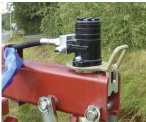
Mit diesem optionalen Hydroantrieb (begrenzt durch Schläuche) steuern Sie die Drehbewegung der Forstzange einfach und komfortabel vom Schleppersitz aus.
