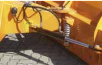
hydraulische Schrägstellung (optional)
