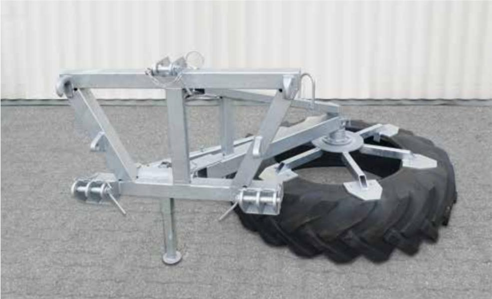
Das Gerät ist mechanisch links oder rechts schwenkbar. Die Aufnahme erfolgt im 3-Punkt-Anbau, am Kupplungsdreieck oder Frontlader (f. Klinkgeräte), über die Kombiaufnahme für EURO, 3-Punkt und Kupplungsdreieck – und auch über die Greifschaufelaufnahme. Der Antrieb des rotierenden Rades erfolgt über den Boden. Die hydraulische Verstellung ist jederzeit nachrüstbar.
