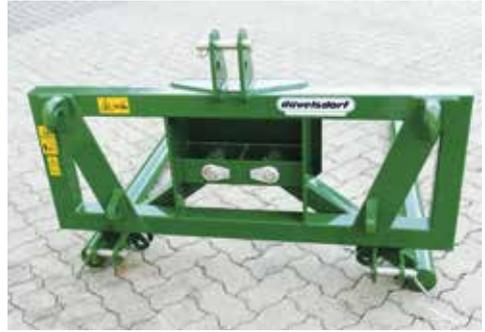
Die Rundballengabel solo ist durch die Aufnahme in EURO und KAT 2 universell einsetzbar. Über die frei beweglichen Arme ist die Aufnahme von Rundballen mit einem Durchmesser von 0,8 m bis 1,8 m ohne Umstellen der Arme möglich. Optional kann die Rundballengabel mit einem Zylinder ausgestattet werden, mit dem sich die Arme hydraulisch öffnen und schließen lassen.
