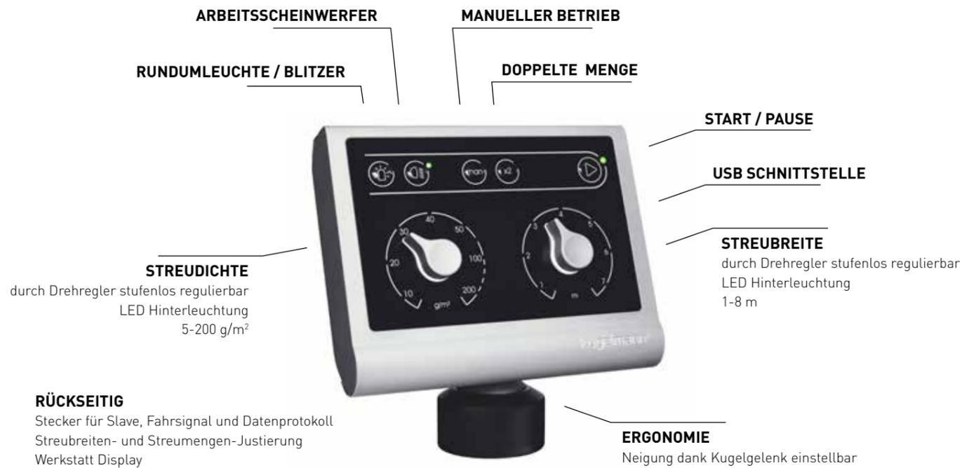
Mit der K-Basic 2 gelang es kugelmann eine aufs Wesentlichste reduzierte Steuerung zu lancieren. Als Schnittstelle zwischen Mensch und Maschine vereint sie intuitive Bedienung und präzise Streutechnologie. Trotz High-tech-Lösung mit intelligenter Rückmeldung und Kontrollfunktion ist die K-Basic 2 leicht verständlich und die Bedienung in kürzester Zeit Routine. Ohne Kompromisse bei der Arbeit haben Sie alles im Griff. Die Steuerung arbeitet
