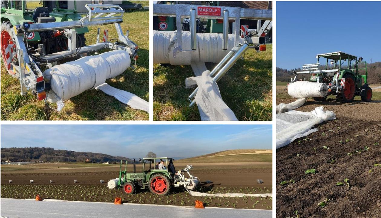
Der Marolf Bobinado kann mit der 3-Punkt Anhängung an die Front- oder Heckhydraulik ihres Traktors angehängt werden.
