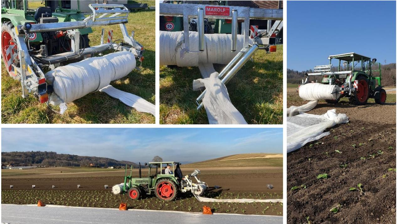
Le Bobinado de Marolf peut être attelé à l'attelage avant ou arrière de votre tracteur grâce à l'attelage 3 points. Les rouleaux de film peuvent être accrochés dans les supports prévus à cet effet. Le dévidoir est entraîné par un moteur hydraulique.
