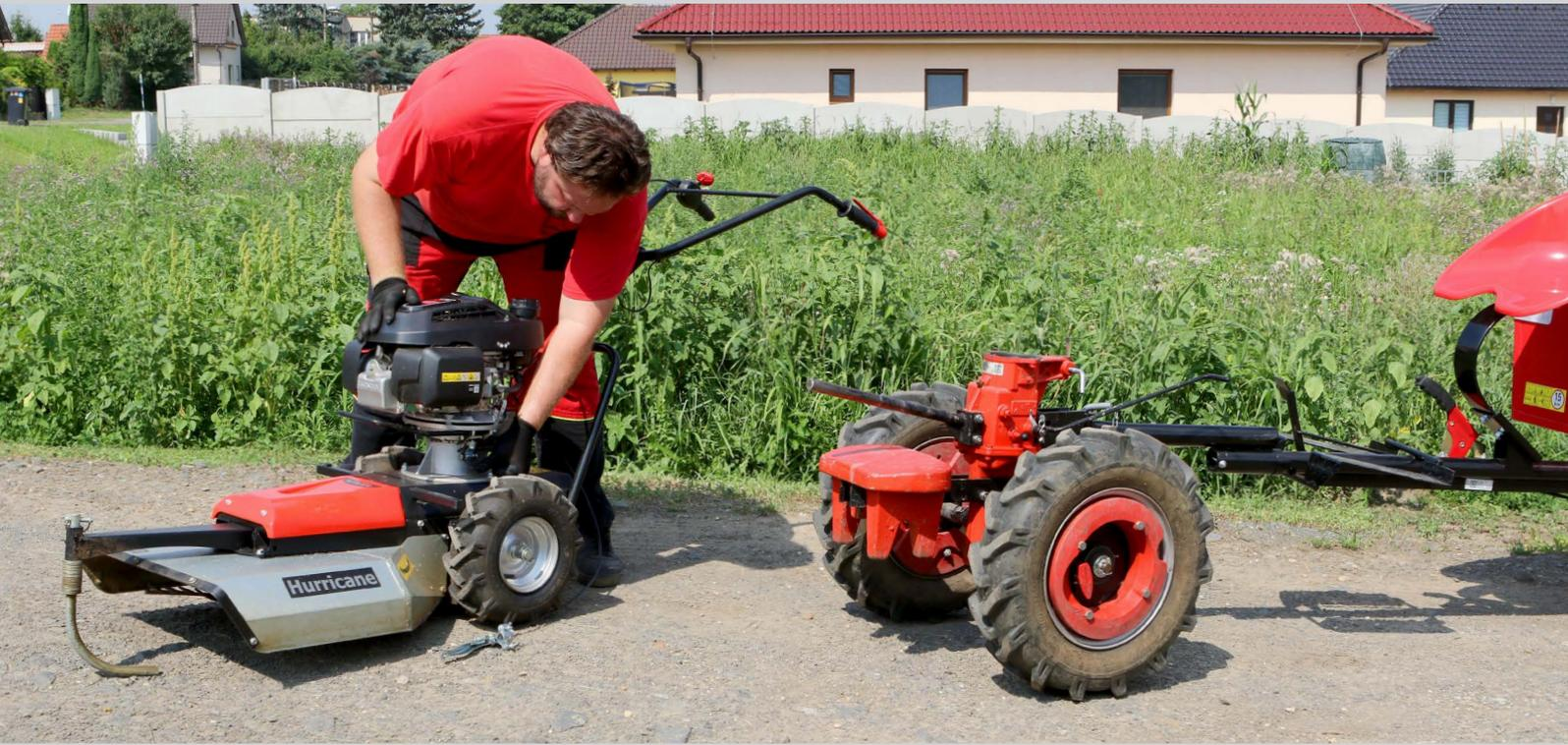
Die Basis des Baukastensystems ist eine Antriebseinheit mit einem Motor, einem Lenkholm und einer automatischen Dreibacken-Fliehkraftkupplung. Sie treibt zwei Getriebe an, **DSK-316** und **DSK-317**, sowie verschiedene **Geräte, die man direkt an die Antriebseinheit anschließt**. Die genialen Vorteile des VARI-Systems sind vor allem Einfachheit, Variabilität und einfaches Transportieren, da man jede Kombination praktisch jedes Mal auf drei Teile zerlegen kann.
