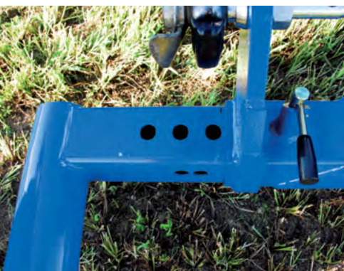
Schnellverschluss für Breitenverstellung
