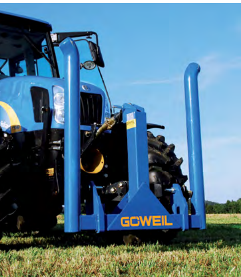
Aufgeklappte Rohre für Straßentransport
