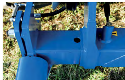
Mech. Breitenverstellung in 50 mm Schritten
