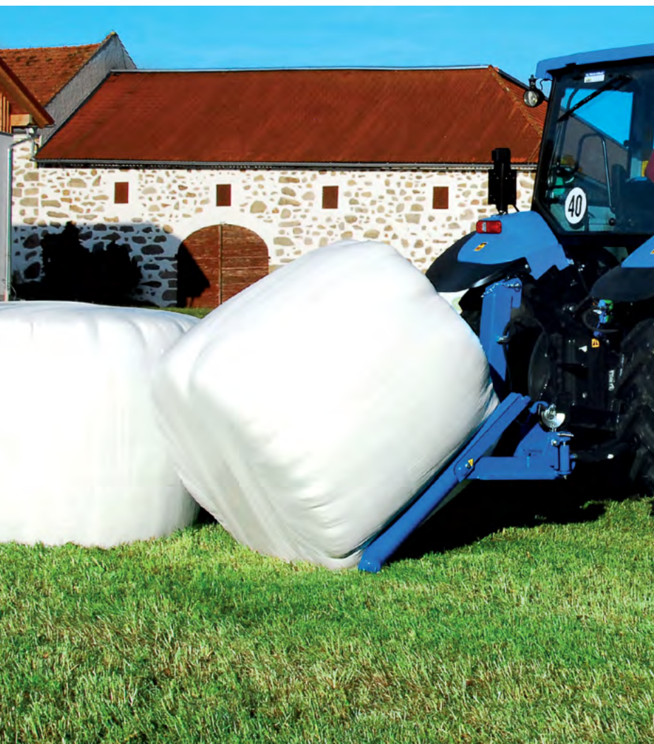
Mech. Breitenverstellung in 50 mm Schritten
