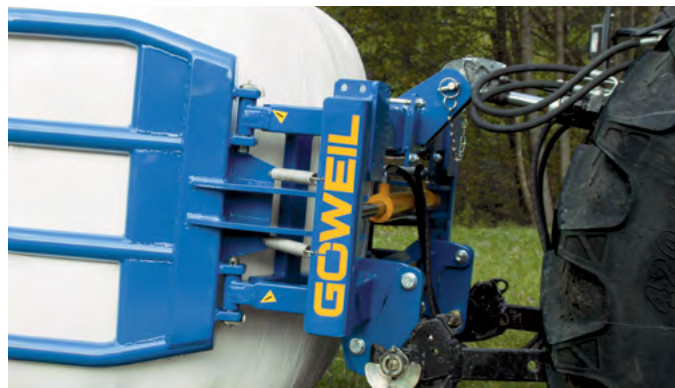
Mögliche Anbauvariante: Dreipunktbau Kat. I und II
