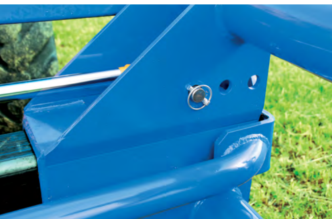
Der Klemmbereich lässt sich manuell um 240 mm verstellen
