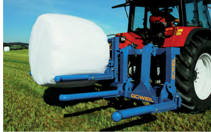
2. Zusatzhydraulik hebt den Ballen um bis zu 380 mm >>
