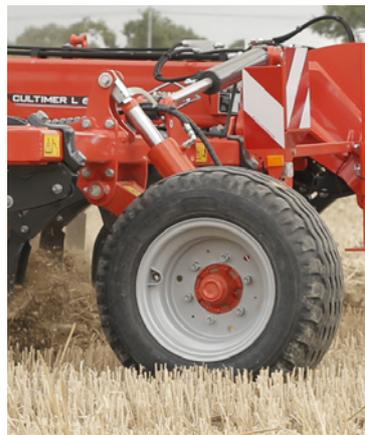
La version traînée peut être équipée de roues de jauge frontales pour un parfait suivi du terrain. Ces dernières sont disponibles avec le même réglage hydraulique par cales pour assurer votre confort.
