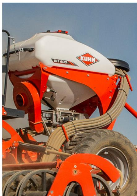
Semoir à couverts végétaux. Pour optimiser votre passage de déchaumage et semer en simultanément vos couverts. Les SH d'une capacité de 200, 380 et 600 litres vous permettent d'être autonome sur vos différents chantiers.
