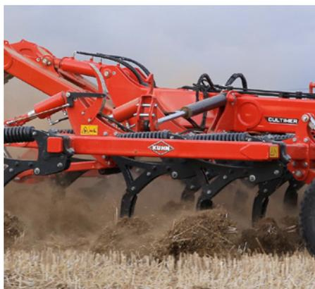
La forme incurvée ainsi que les déflecteurs vrillés permettent un mélange homogène terre et paille. Le flux de matière est divisé :
