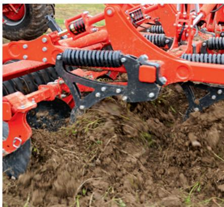
La position de la pointe et sa courbure lui confèrent une capacité de pénétration incomparable. De plus, cette forme de dent, garantissant un mélange optimal, demande moins de puissance qu'une dent droite, réduisant ainsi vos coûts d'utilisation. Il en est de même pour un déflecteur vrillé comparé à un déflecteur droit.
