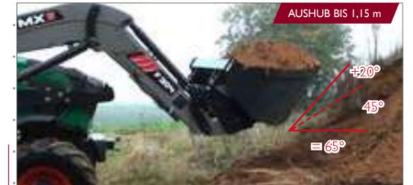
\*Aushubreserve: + 20° Aushubreserve bei einer Höhe von 1,15 m dank der Kinematik des Frontladers und der Abmessungen der An-/Auskippszylinder.
