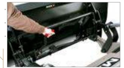
Schnellwechselrahmen mit automatischer Verriegelung. Entriegelungsgriff, von außen zugänglich.
