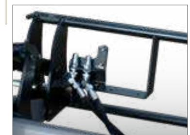
Leichter Zugriff auf die 3. Funktion für Werkzeuge mit Hydraulikantrieb.
