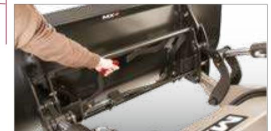
Schnellwechselrahmen mit automatischer Verriegelung. Entriegelungsgriffe sind von beiden Seiten des Rahmens aus zugänglich.
