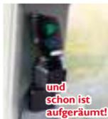
Wenn der Frontlader abgekoppelt ist, wird der Griff e-PILOT S in eine Ablageschale oder in eine für diesen Zweck vorgesehene „Parkposition“<sup>1</sup> gelegt. Somit ist der gesamte Arbeitsbereich frei für andere Aufgaben.
