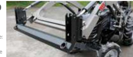
Dieser optional erhältliche Schnellwechselrahmen ermöglicht einen einfachen Werkzeugwechsel durch einfachen manuellen Anschluss. Er ist für die Montage von 2 MANUBAL-Zinken oder der Stangen TRC500 für die Handhabung Ihrer Paletten vorgerüstet.
