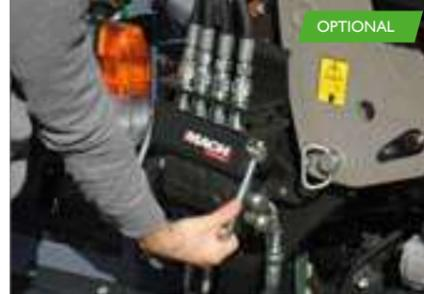
Der Schnellkuppler MACH System®, die sichere Verbindung zwischen Schlepper und Frontlader\* [Seite 50](#)
