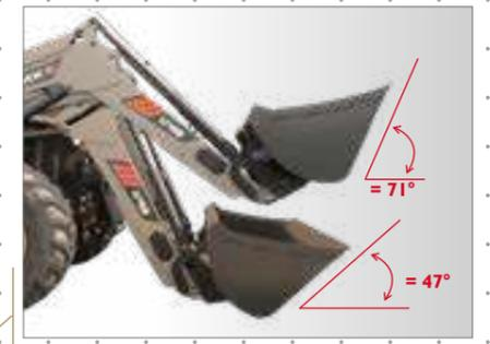
Ankippwinkel für maximale Leistung: bis 71° in 1,20 m Höhe.
