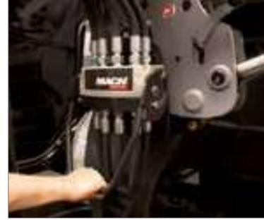
Der Schnellkuppler MACH System®, die sichere Verbindung zwischen Schlepper und Frontlader.
