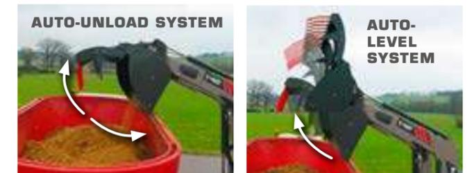
Mit dem AUTO-UNLOAD System kann eine Ladung durch gleichzeitiges Betätigen der Öffnung des Greifers und des Auskippens der Schaufel entleert werden. Das AUTO-LEVEL System sorgt danach für die automatische Rückstellung der Schaufel in die Waagrechte.
