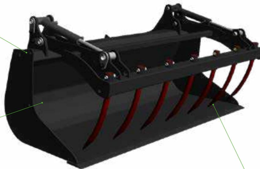
Von der Verschleißkante zurückgesetzte Greiferzinken, um das Material vom Fuße der Wand aufzunehmen
