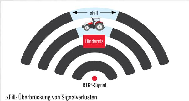
**Ganz genau.** Das automatische, DGPS-basierte Lenksystem S-Guide arbeitet mit höchster Präzision bei einer wiederholbaren Genauigkeit von bis zu 2,5 cm (RTK+). Es gewährleistet nicht nur eine parallele Spurführung, sondern kann mit S-Turn II automatisch am Ende der Fahrgasse wenden und durch Eingabe der Vorgewende-Grenzen auch jenes optimal bearbeiten. Somit besteht selbst bei schwierigen Bodenverhältnissen und schlechter Sicht kein Risiko, dass Überlappungen oder Lücken am Feld entstehen.
