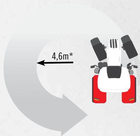
\* Min. Wenderadius mit gefederter Vorderachse, Spurweite 1.830 mm und Vorderradbereifung 14.9R28.
