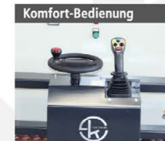
Komfort-Bedienung Elektro-hydraulische Steuergeräte mit Bedienung über Joystick
