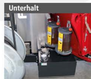
Unterhalt Gute Zugänglichkeit für Wartung und Service, kleine Ölmenngen
