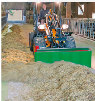
Einsatz mit Hoflader, Anbau EURO8 oder Universal mit Schwerlast-Stützrollen
