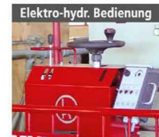
Elektro-hydr. Bedienung Elektro-hydraulische Bedienung bei mehr als zwei Funktionen am FMW
