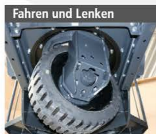
Fahren und Lenken Radgetriebemotor mit automatischer Bremse und +/-70° Lenkeinschlag
