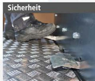
Sicherheit TOT-Mann-Steuerung: automatische Betriebs- und Feststellbremse
