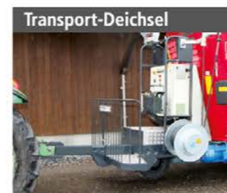
Transport-Deichsel Steck-Deichsel für den Transport mit dem Traktor, max. 8km/h
