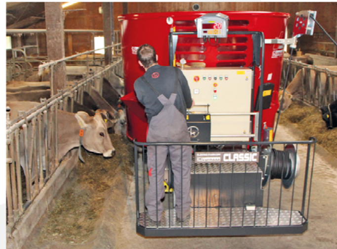
Der geschützte Führerstand, die automatische Betriebs- und Feststellbremse, sowie die gute Übersicht erzeugen Sicherheit bei der Arbeit.
