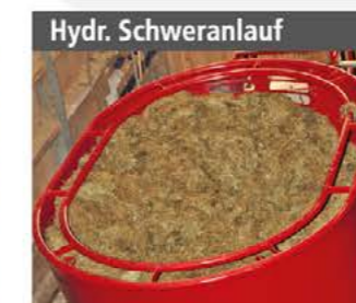
Hydr. Schweranlauf Start der Mischschnecke bei abge-sacktem oder verklemmtem Futter
