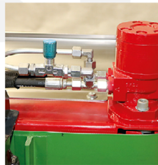
Antrieb hydraulisch mit stufenloser Geschwindigkeitsverstellung
