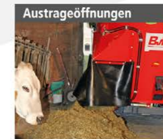
Austrageöffnungen Links / rechts, vorne / hinten / seitlich, mit Rutschen oder Elevator
