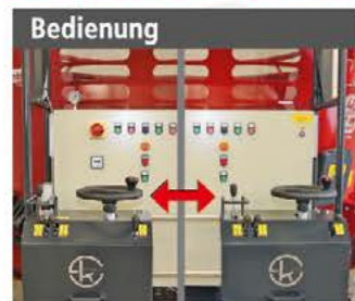
Bedienung Ergonomische Bedienung mit Lenkrad, links / rechts schiebbar
