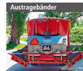
Austragebänder Querförderband hi / vo, Steigbänder für Austrageöffnung/Querförderband
