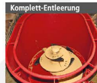
Komplett-Entleerung Schnell-Austrag mit Übersetzung 1:3 verhindert Erwärmung von Restfutter
