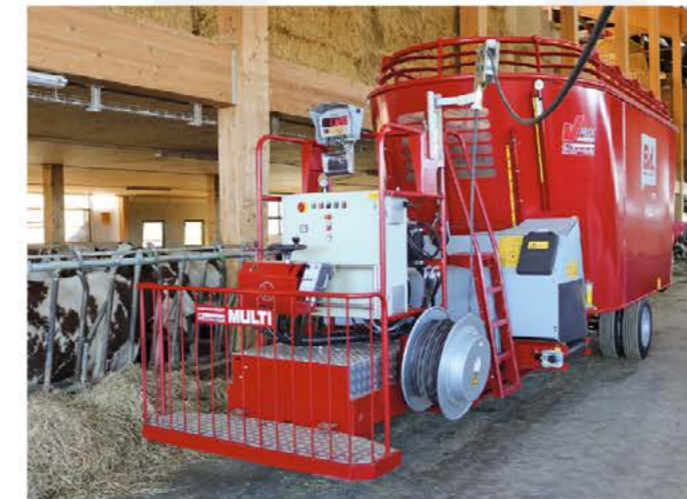
Elektrofahrkopf MULTI mit 30kW Getriebemotor verbaut an einem BvL Futtermischwagen V-MIX Plus 24-2S mit Querförderband vorne.
