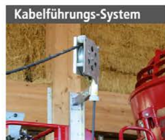
Kabelführungs-System Massive Kabelführungen mit grosser, schwenkbarer Umlenkrolle
