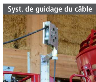
Guides de câbles massifs avec grande poulie de renvoi pivotante
