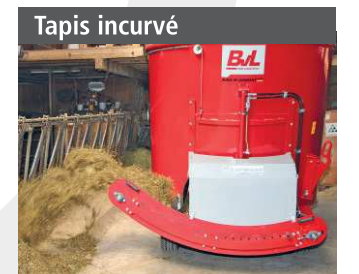
Mangeoires jusqu'à 90cm, réglable gauche/droite, hydraul. en option
