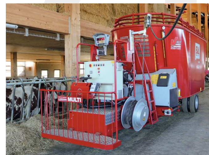
Tête automotrice électrique MULTI avec moteur-réducteur de 30 kW monté sur une mélangeuse V-MIX Plus 24-2S BvL avec tapis transversal avant.
