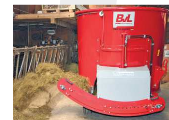
De tapis incurvé permet de distribuer dans des mangeoires jusqu'à 90cm de hauteur.
