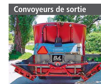
Tapis d. sortie ar/av, conv. ascendants pour ouvert. de décharge / tapis transv.
