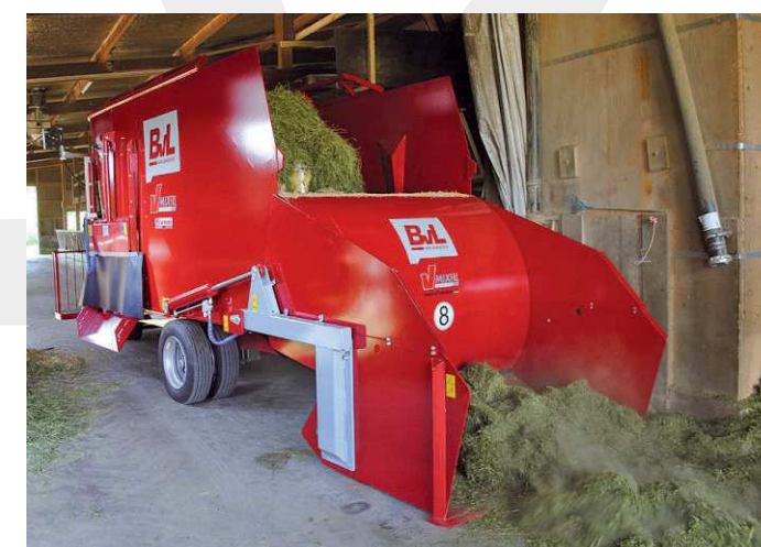
Tête automotrice électrique MULTI utilisée avec une mélangeuse d'aliments BvL V-MIX FILL Plus 17-2S L avec porte de chargement.
