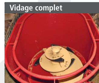
Le vidage rapide avec rapport 1:3 empêche l'échauffem. du fourr. résiduel
