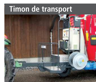
Timon enfichable pour le transport avec le tracteur, max. 8km/h
