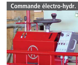
Commande électro-hydr. pour plus de deux fonctions sur la mélangeuse
