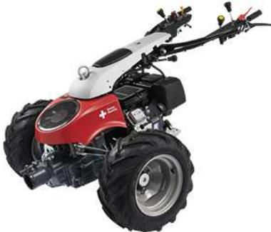
Das Profimodell. Der CC 66 ist in zwei unterschiedlichen Leistungsvarianten erhältlich. Der 2-Zylinder Benzinmotor mit 18 oder 23 PS lässt keine Wünsche offen.
