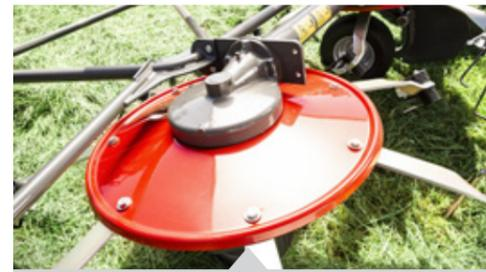
Große Kreisel bedeuten hohe Zinkengeschwindigkeit bei niedriger Drehzahl.
