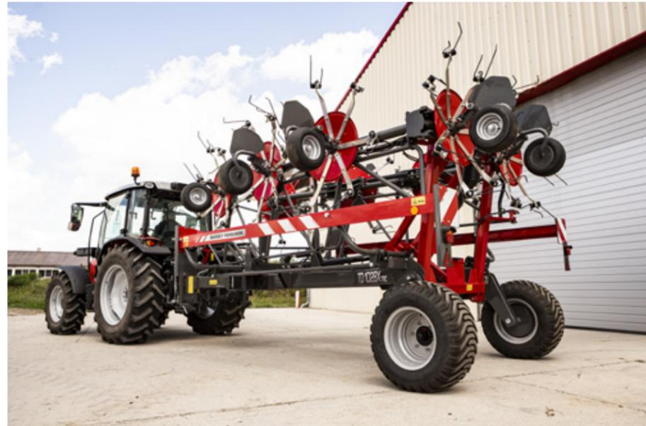
**Transportstellung:** Für die Straßenfahrt werden die Kreisel auf dem Rahmen abgelegt. Das schützt die Drehgelenke, denn in eingeklapptem Zustand sind sie so keinerlei Beanspruchung ausgesetzt. Durch die spezielle Transportposition, bei der die Kreisel hintereinander aufgereiht sind, sind selbst die größeren MF TD X Modelle noch schmal genug für sicheren Straßentransport.
