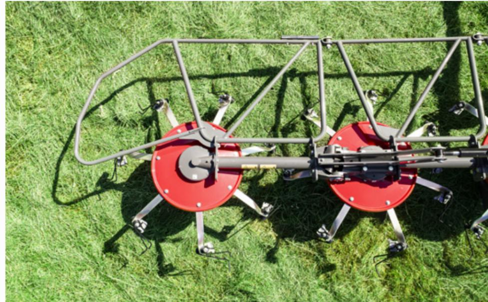
Der Gitterrahmen sorgt für den nötigen Schutz und verstärkt den Hauptrahmen.
