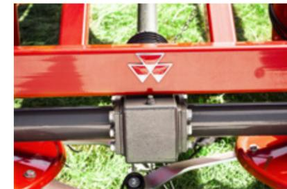
Geringe Betriebskosten und unkomplizierte Wartung dank der wartungsfreien Kreuzgelenke, den gut zugänglichen Gelenk-Schmiernippeln und dem Getriebe mit Ölfüllung.
