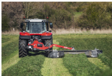
Mähbalken mit flachem Profil und Stirnradantrieb
