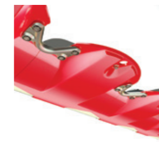
Stromlinienförmiger Mähbalken (Unterseite)
