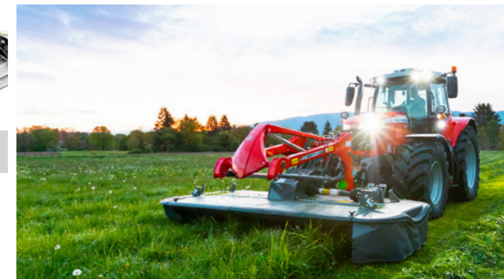
Mähbalken mit flachem Profil und Stirnradantrieb
