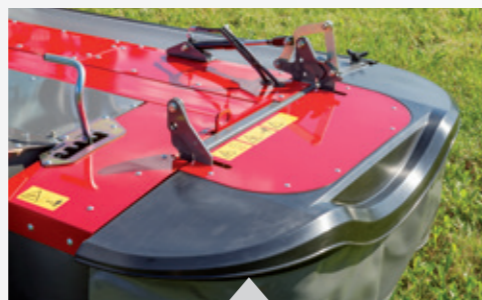
Einfache Einstellung des Aufbereiters
