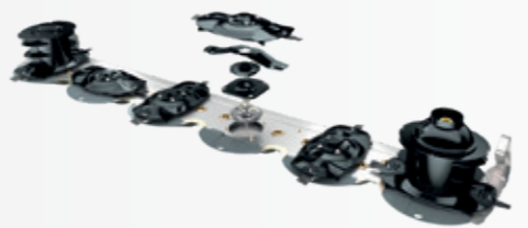
Mähbalken mit flachem Profil und Stirnradantrieb
