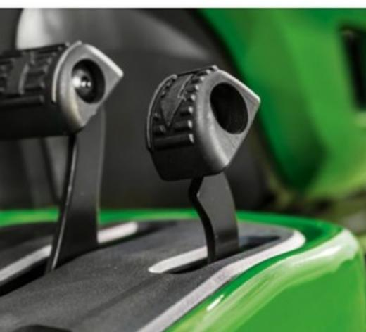
**Intuitive Getriebesteuerung:** Mit diesen nebeneinander liegenden Fahrpedalen steuern Sie bequem Richtungswechsel und Fahrgeschwindigkeit. Das dem Gaspedal bei Pkw ähnliche Bedienelement gewährleistet eine einfache Bedienung und die große Pedaloberfläche sorgt für hervorragenden Komfort beim Fahren. Die Motordrehzahlbegrenzung erleichtert das Fahren.
