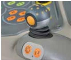
↪ Mit dem Variostick beschleunigen Sie den Fendt 200 Vario stufenlos aus dem Stillstand bis zur gewünschten Geschwindigkeit, von 0 – 40 km/h vorwärts und 0 – 25 km/h rückwärts – ohne Kriechgang- oder Gruppenschaltung.
