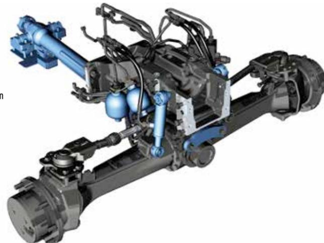
Die Vorderachsfederung bietet einen Gesamtfederweg von 90 mm und hat dabei einen Pendelwinkel von 20 Grad. Durch die Niveauregulierung bleibt der Federungskomfort unabhängig von der Zuladung gleich gut. Damit ist jederzeit ein sicheres Brems- und Lenkverhalten des Fahrzeugs gewährleistet.
