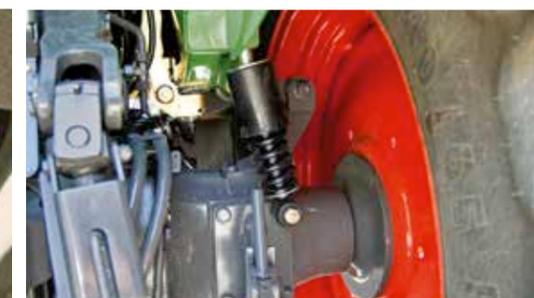
➡ Die Kabine des Fendt 200 Vario ist dank der optionalen Federung optimal auf der Hinterachse gelagert. Stöße und Vibrationen werden über die Feder-elemente, bestehend aus Stoßdämpfern und Querstabilisatoren, abgefangen.
