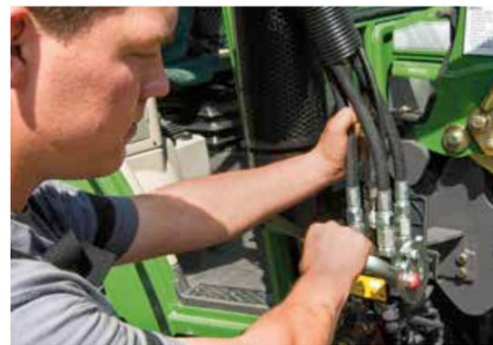
Der Multikuppler dient zum Anschließen aller hydraulischen und elektrischen Leitungen – frontladerseitig auch unter Druck. Damit ist der An- und Abbau des Frontladers in kürzester Zeit erledigt.
