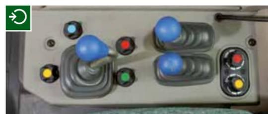
■ Mit dem Kreuzschalthebel können das 1. und 2. Ventil sehr feinfühlig bedient werden.
