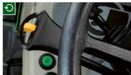
□ Mit dem Reversierhebel wird ganz bequem mit der linken Hand die Fahrtrichtung gewechselt.
