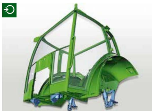
□ Auf Wunsch lässt sich der Fendt 200 Vario mit einer Kabinenfederung ausstatten. Vorne ruht die Kabine auf Gummikonuslagern, sodass sie schwingungsfrei mit dem Schlepperrumpf verbunden ist. Über das Schraubenfederungs-Stoßdämpfersystem der hinteren Kabinenfederung werden Stöße auf ein Minimum reduziert.
