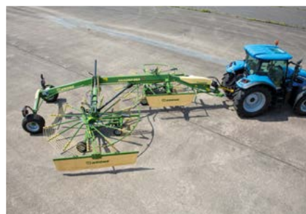
Swadro TS 740 Twin Arbeitsbreite 7,40 m / (2x 4,10 m)
