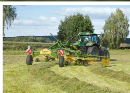
Swadro TS 620 Twin Arbeitsbreite 6,20 m / (2x 3,46 m)
