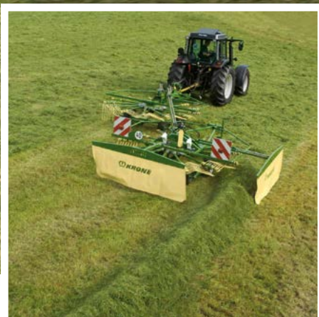
Einschwadablage Ein Schwad aus 6,20 m
