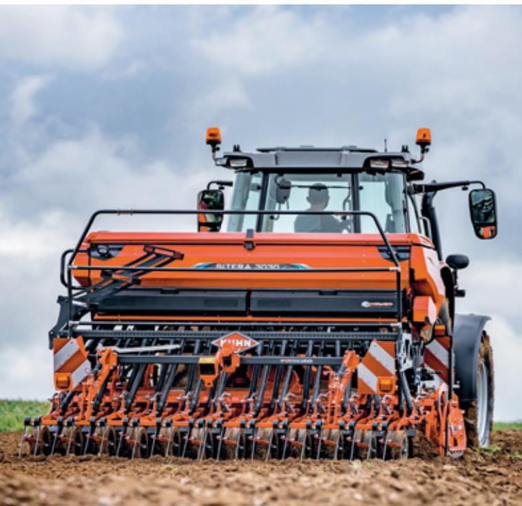
DÉCOUVREZ L'EFFET ÉLECTRIQUE. Le semoir mécanique SITERA possède désormais une distribution animée par entraînement électrique. La modulation du dosage peut être ajustée manuellement ou automatiquement par GPS via un terminal ISOBUS (avec fonction TC-GEO).
